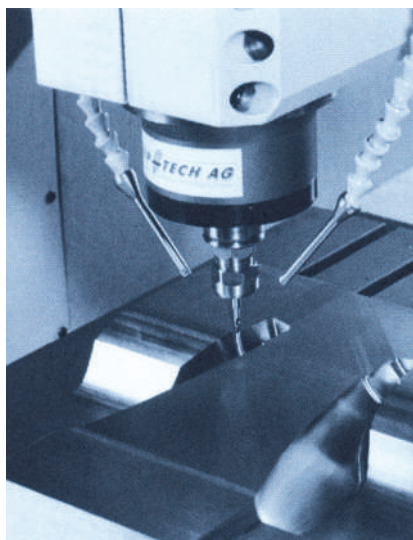
Il mandrino HVC 140 è stato il primo mandrino ad alta velocità prodotto in serie da STEP-TEC. Con una velocità di 42.000 giri/min su cuscinetti ibridi in ceramica e in combinazione con l'accelerazione dell'asse di 1 g dell'HSM 700, nel 1996 per la prima volta la fresatura industriale ad alta velocità è diventata realtà
