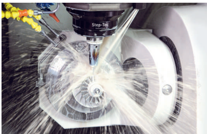
Precisione dimensionale garantita durante la fresatura con refrigerante, grazie all'Intelligent Thermal Control (ITC)
