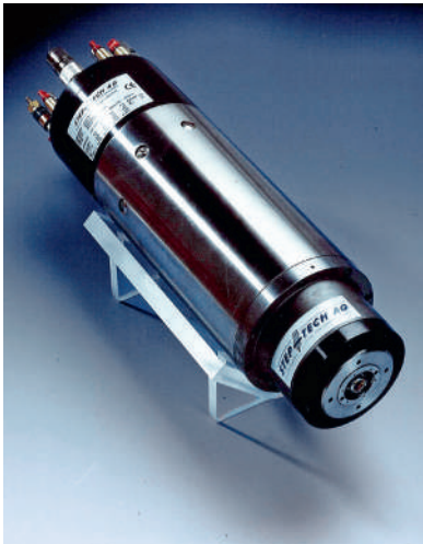
Die HVC 140-Spindel war die erste Hochgeschwindigkeitsspindel in Serienfertigung von STEP TEC. Mit einer Geschwindigkeit von 42.000 U/min auf keramischen Hybridlagern und in Kombination mit der 1g-Achsenbeschleunigung der HSM 700 wurde 1996 erstmals das industrielle Hochgeschwindigkeitsfräsen Realität
