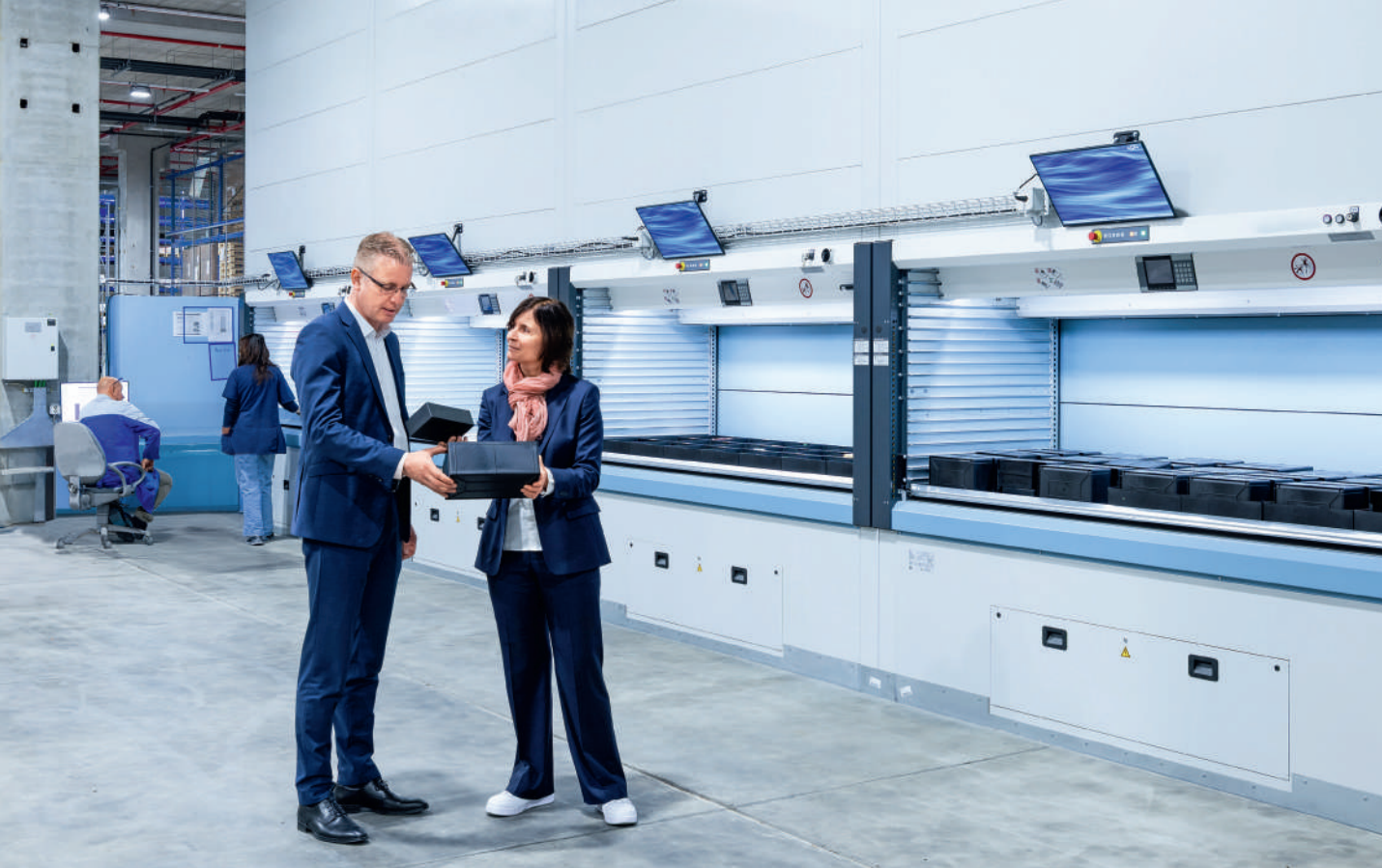
Die intern produzierten Elektronik-Komponenten sind über Paternoster-Lagersysteme in den Warenfluss eingebunden
