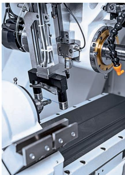
*Système de mesure Laser Contour Check dans une rectifieuse d'outils de WALTER*
